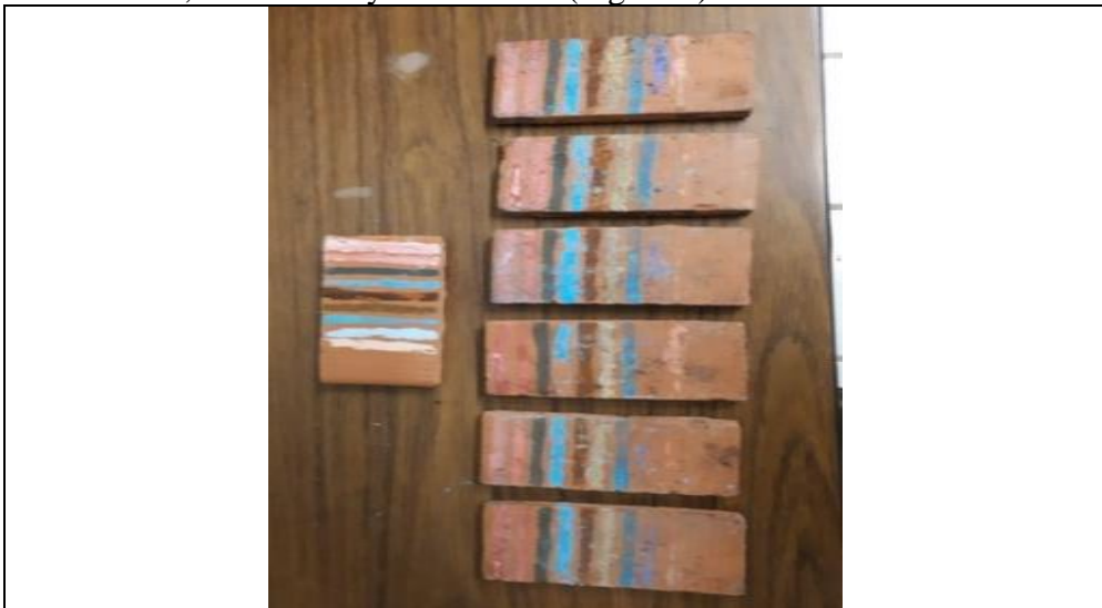
Figura 3. Placa de cerámica con indicadores de temperatura.
