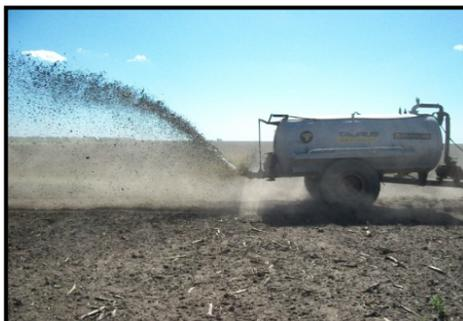
Figura 1: Aplicación de efluente con tanque presurizado
