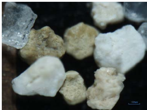
Fig. 10. Glauconites allochtones délavées de la cote 20m (GX6).
