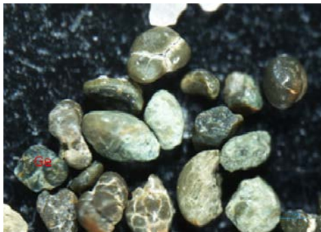
Fig. 8. Glauconites para-autochtones à craquelures de la cote 51m à la cote 50m (GX3) avec des microexfoliation (Ge)
