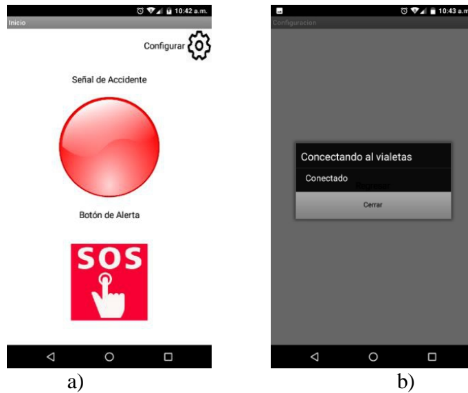
Figura 2.- Aplicación complemento de la RNA, a) para emitir alertas y configurar datos del conductor y del vehículo y b) conectarse a las vialetas solares autónomas.
