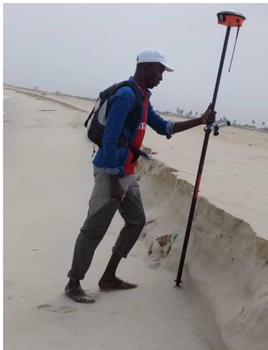
Photo 2. Mesure topographique au DGPS
