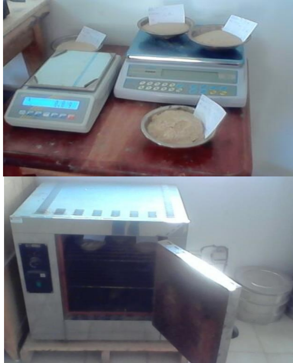
Photo 1 et 2. Balance électrique de précision et Étuve de séchage (Seck, 2019)
