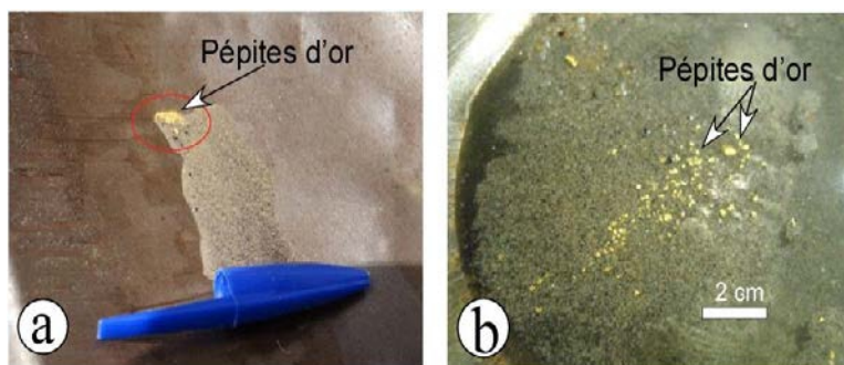
Figure 6. Aspect des paillettes d'or dans les sédiments : en (a) dans le sable quaternaire, en (b) dans le grès conglomératique du Crétacé
