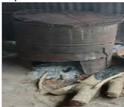
Figure 5: Foyer en tonneau de fer
