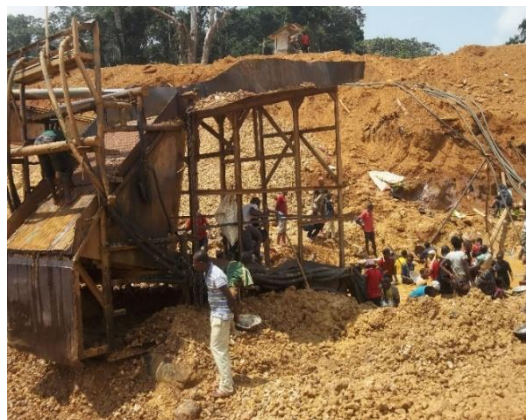
Photo 4. Lavage semi mécanisé sur le site Maud 1
