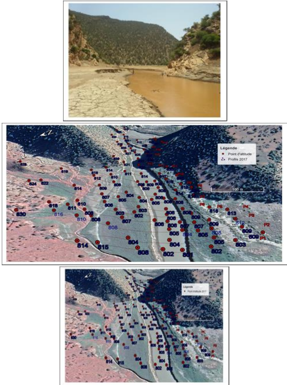
Figure.6: Présentation du MNT du tronçon étudié de la campagne de levé de juillet 2017.
