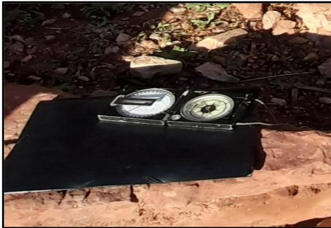
**Figure 9.** Boussole de mesure des pendages
