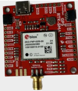
Figura 3. Receptor GNSS de bajo costo modelo ZED-F9P-02B-00. Fuente: elaboración propia.
