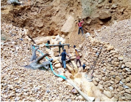
Photo 3 : Exploitation artisanale d'un gisement éluvionnaire avec adduction d'eau
