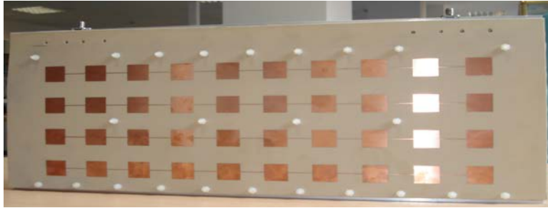
a. Vista de la cara radiante de la antenna.
