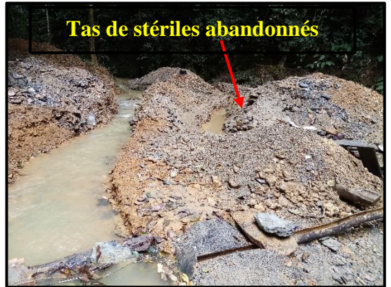
Photo 20 : Tas de stériles abandonnés et destruction du chenal principal
