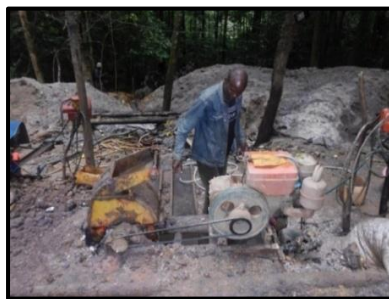
Photo 14 : Broyage et lavage semi-mécanisé
