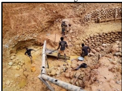
Photo 16 : Débourageage (Lavage à partir d'une caisse)
