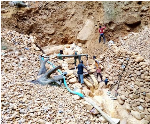
Photo 3 : Exploitation artisanale d'un gisement éluvionnaire avec adduction d'eau
