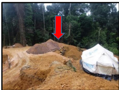
Photo 13 : Entassement de gravier avant lavage
