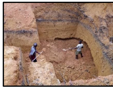
Photo 9 : Fonçage du puits, site artisanal
