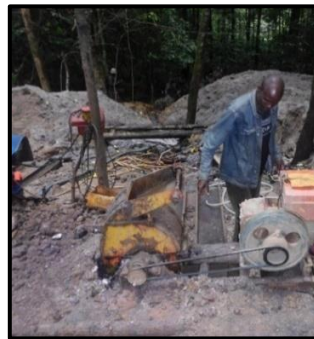
Photo 14 : Broyage et lavage semi-mécanisé
