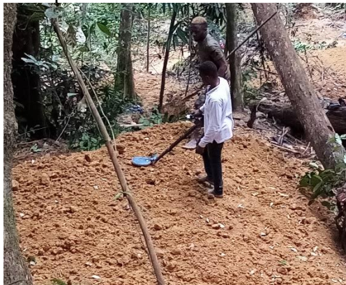
Photo 1 : Exploitation artisanale avec détecteur des métaux, d'un gisement éluvionnaire
