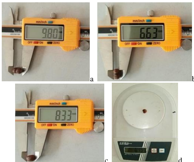
Figure 2: mesure des variables de taille et de poids des graines avec un pied à coulisse ; longueur (a), largeur (b), épaisseur (c) et masse (d)
