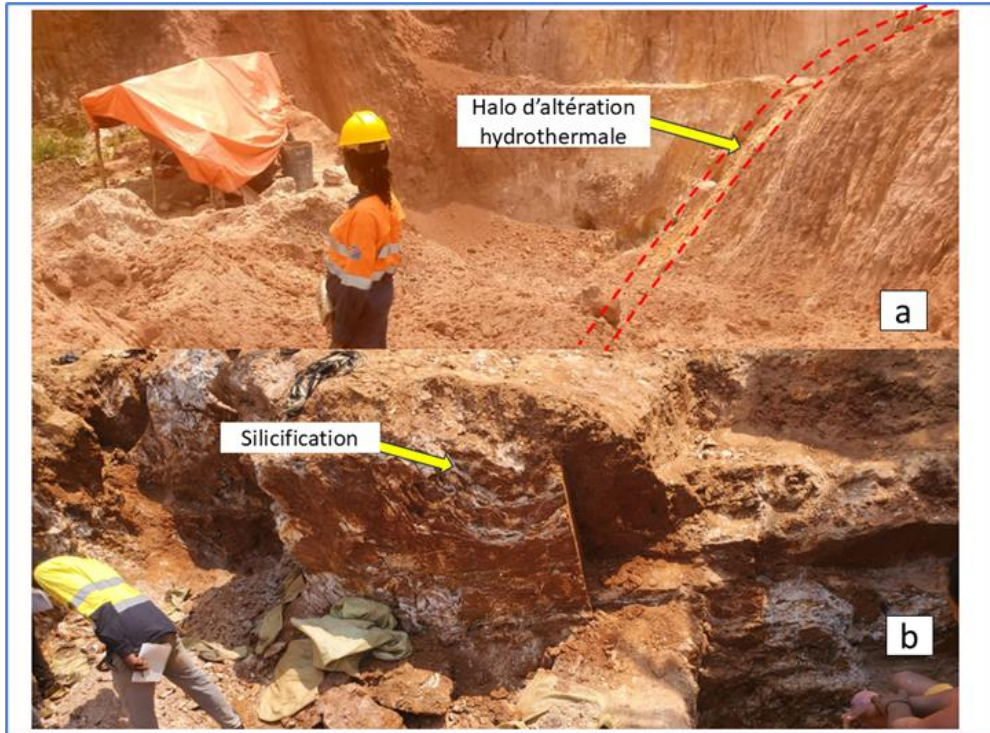
Figure 9 : (a) On observe sur cet affleurement de schiste une forte silicification dans un filon quartz minéralisé en Or au contact avec une mince couche de kaolinite, et cette couche de Kaolinite sert de marqueur d'halo d'altération hydrothermale autour de ce filon aurifère ; localisé dans un puits d'exploitation artisanale de l'or (b) Un affleurement de schiste très silicifié par altération hydrothermale porteur de la minéralisation dans cette région
