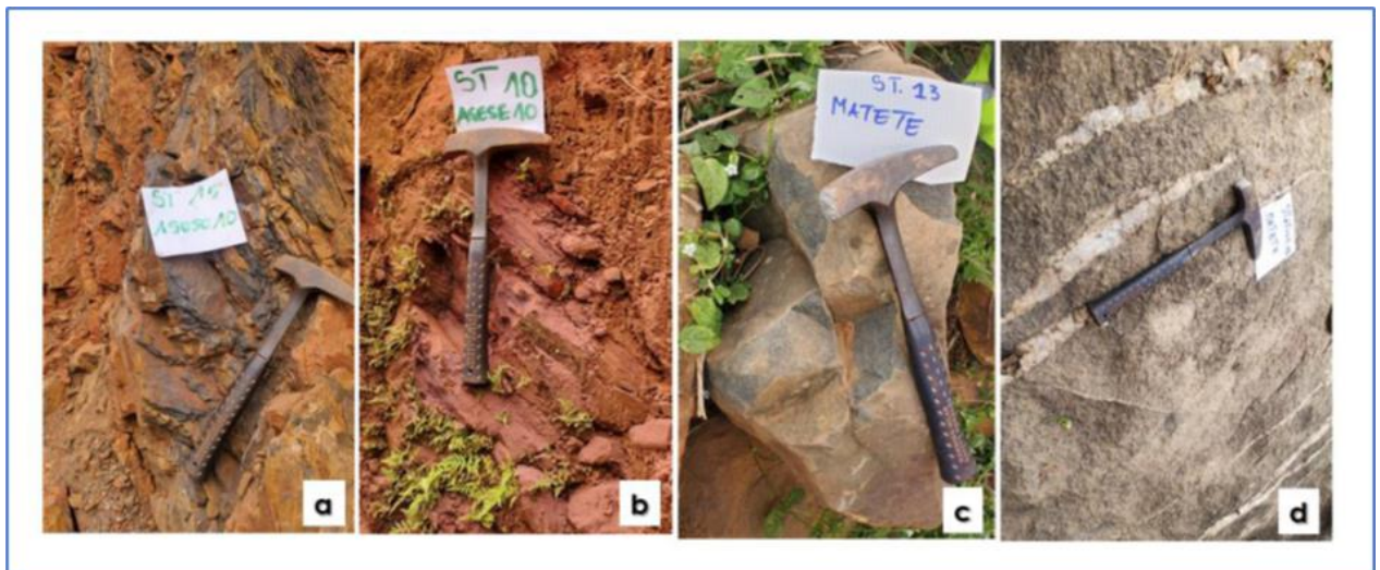
Figure 5 : Les faciès lithologiques observés sur terrain ; (a) bif, (b) schiste, (c) dolérite, (d) granite.
