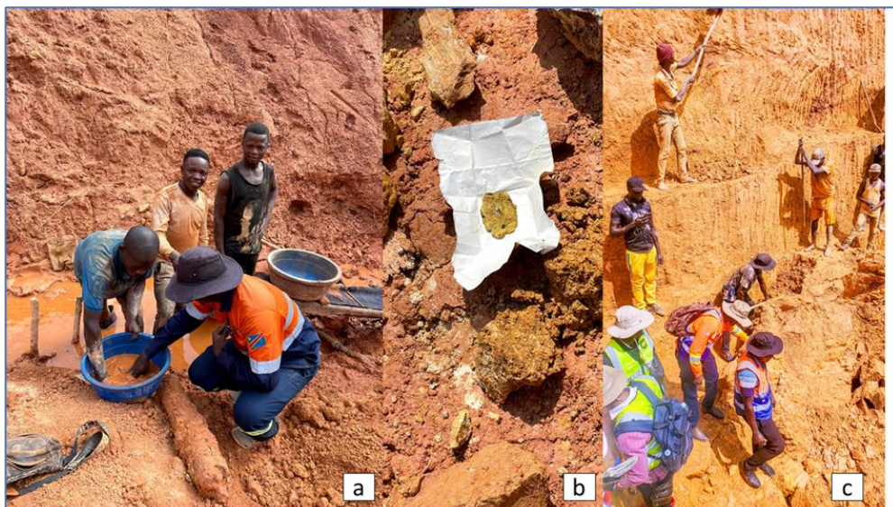
Figure 11 : (a) lavage à la batée ou panning (affinage manuel pour séparer l'or) (b) l'or concentré (c) exploitation artisanale de l'or par les orpailleurs. Situés dans la zone considérée comme cible priorité 1
