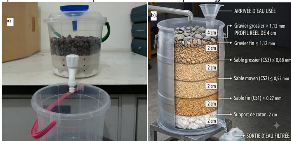
Figure 1 : Schéma du filtre Sable-Gravier
