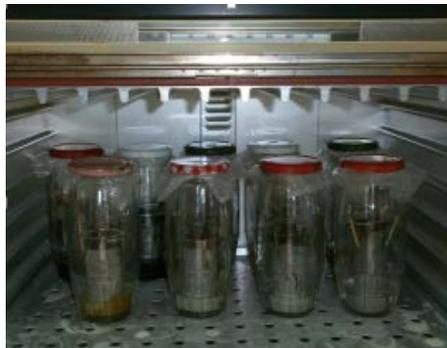
**Figure 1: Dispositif expérimentale pour la détermination des isothermes d’adsorption**
