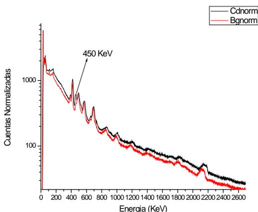
Fig. 8. Gamma spectrum. Sample: cadmium.
