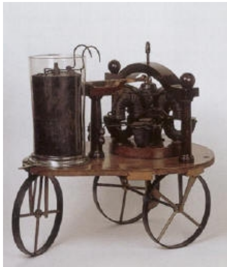
Fig. 2. Coche eléctrico construido por el profesor Stratingh
